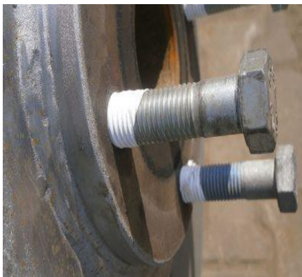
POPRAWNIE zabezpieczenie gwintów taśmą teflonową
