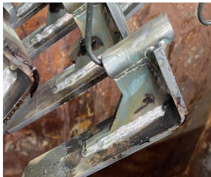
NIEPOPRAWNIE powierzchnia po opryskach
