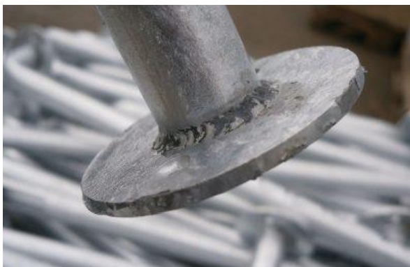
NIEPOPRAWNIE nieoczyszczone spoiny
